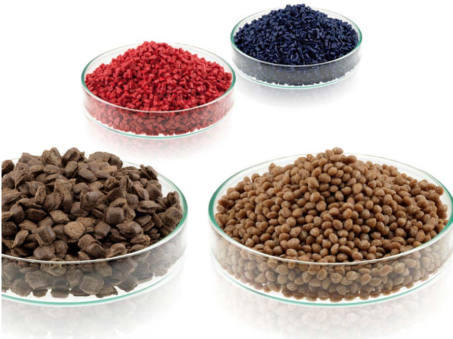
Die Werkstoffe der Firma TECNARO sind biobasierte Granulate, die nach Erhitzen und Einschmelzen analog zu Kunststoffen verarbeitet und eingesetzt werden können.
