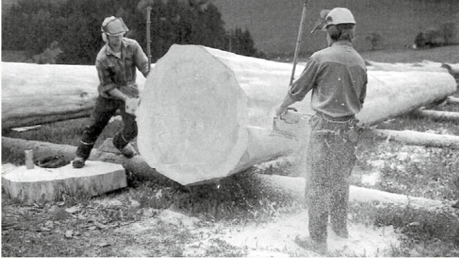
Zur besseren Trocknung wurden die Tannenriesen für die EXPO 2000 mit einer Spezialsäge aufgetrennt. Bild: Pfersich
