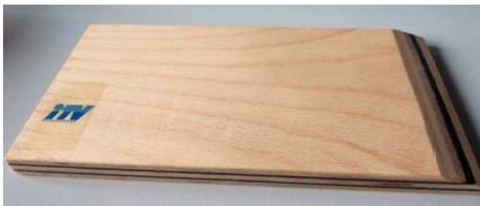
Holz-Carbon Verbund mit hervorragender Tragfähigkeit.
