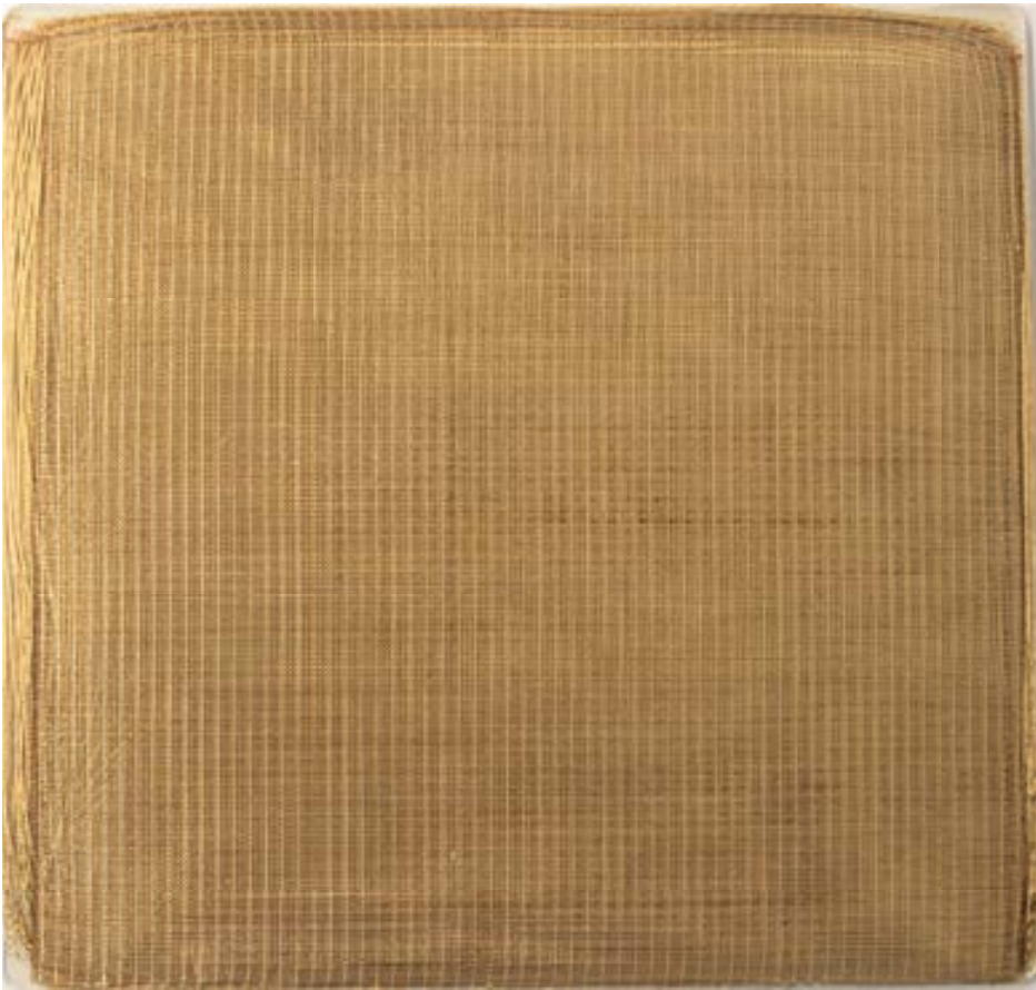
Bio-Faserverbundwerkstoff „Cellun“ aus 100 % recycelbarer Cellulose.
